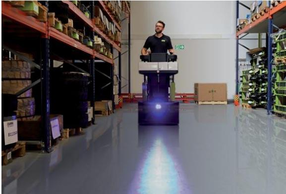
**Image 4 :** Pour les travaux dans des lieux mal éclairés ou comme avertissement, la machine dispose d'un éclairage LED intégré à l'avant dans le châssis
